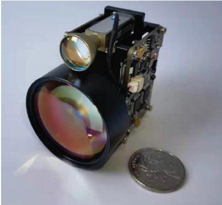
EXA-KM8S 是一款模块化激光测距仪，整机重量仅 150g，探测距离可达 8km。具有强大的环境适应性和优良的产品可靠性，可完美的适配各类光电平台使用。
